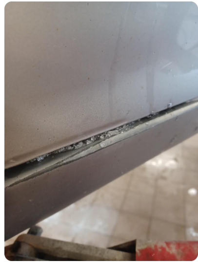
1.1 Noen riper og småbulker
