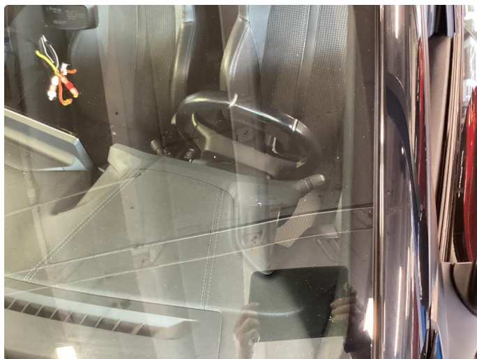
1.6 Steinsprut med sprekk
