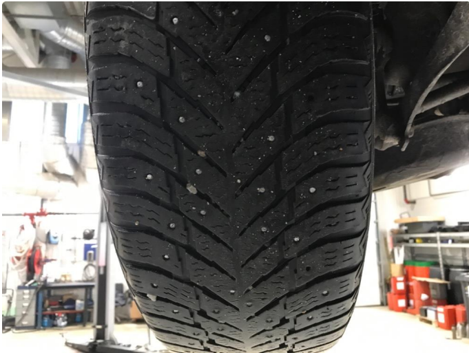
1.1 Piggdekk mangler pigger
