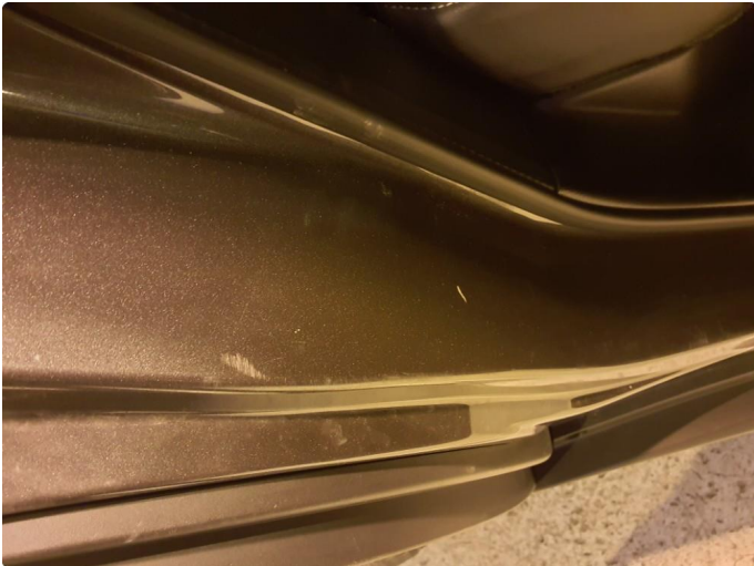
1.1 Noen riper ved døråpning
