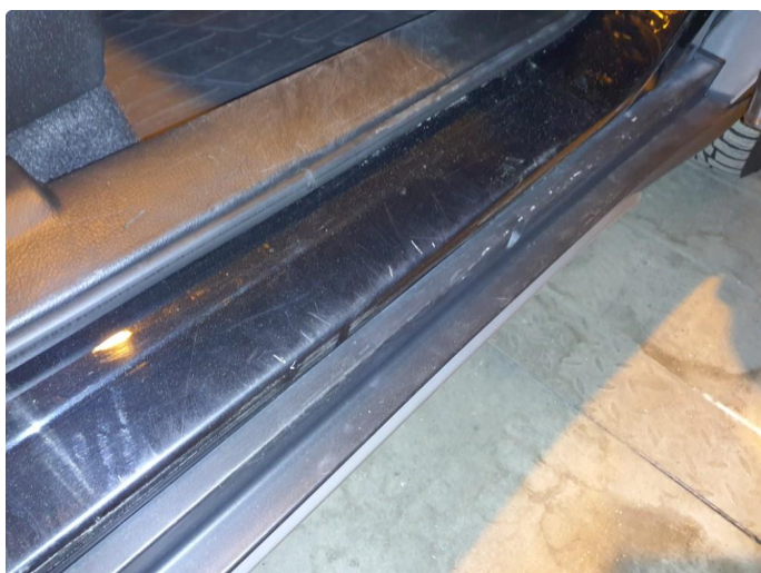
1.3 Noen riper ved dørterskel
