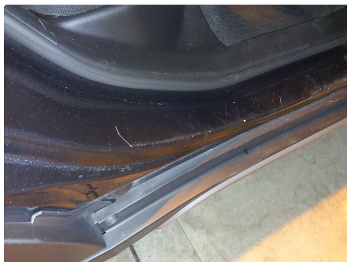
1.3 Noen riper ved dørterskel
