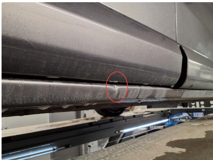
2.10 Bulk i kanal
