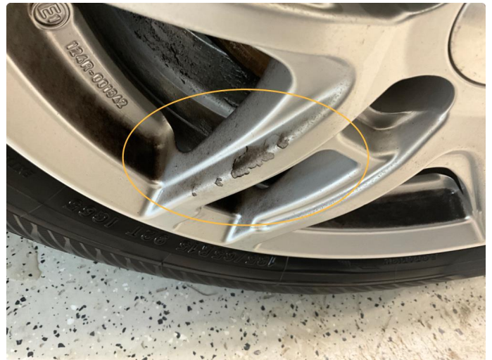
1.2 Noe lakk har sluppet på felgen. Høyre foran.
