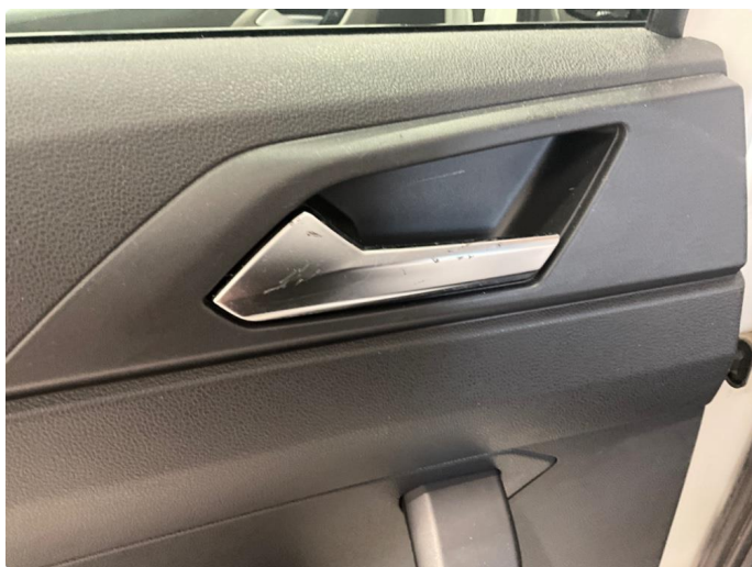
2.1 Noe slitasje på håndtak og på dørtrekket. Venstre bak.
