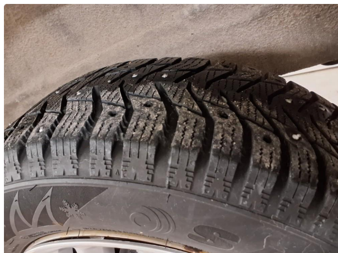
1.2 Piggdekk mangler pigger
