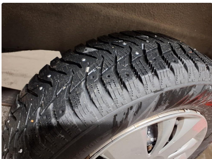
1.2 Piggdekk mangler pigger
