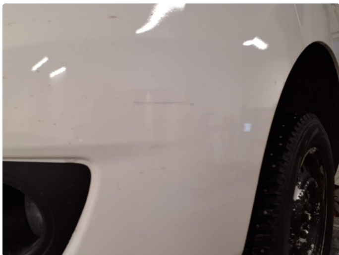
1.6 Riper ned til grunning
