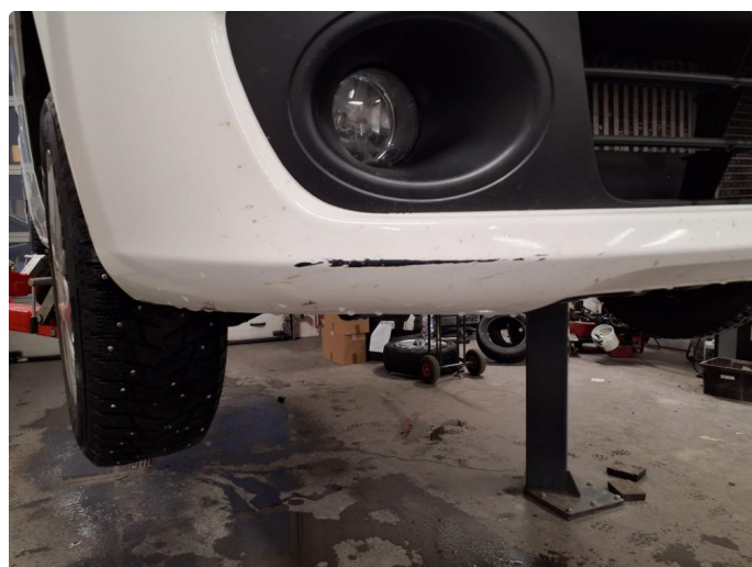
1.6 Riper ned til grunning
