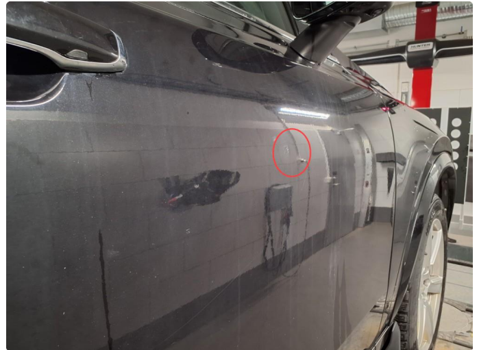
1.3 Liten bulk med lakkskade høyre dør foran
