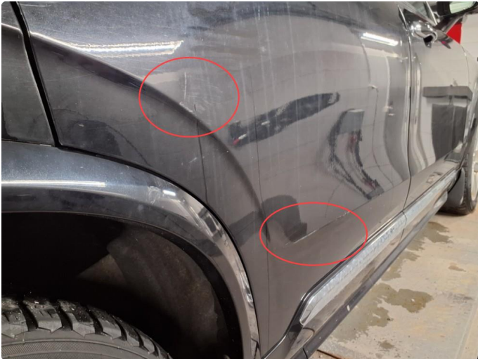
1.2 Noe merker i dør høyre bak
