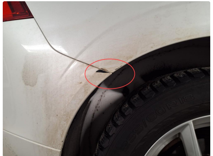
1.5 Lakkflask / slitasje i skøyt mellom støtfanger bak og skjerm. Høyre side
