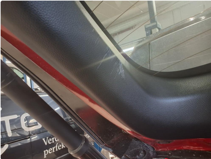
1.1 Merker i plast på bakluke, innside ved bakrute.
