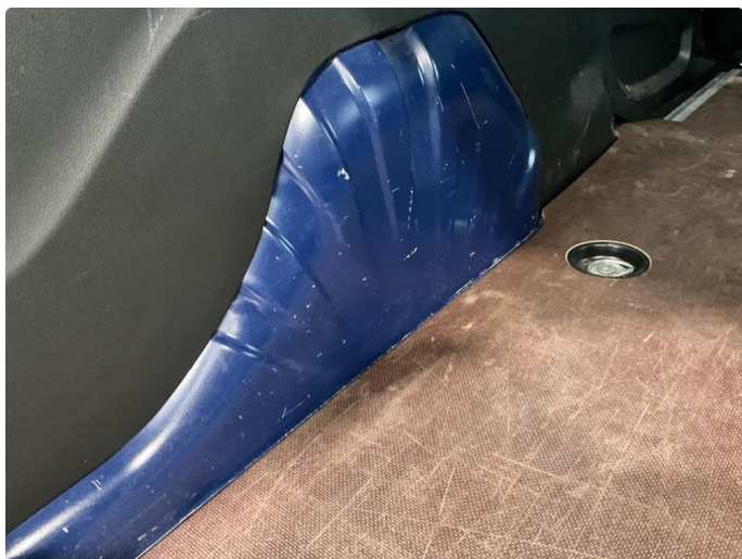
2.2 Noe slitasje i varerom.
