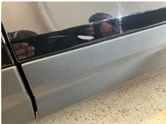
1.1 Mangler en flekk med lakk, over plastlist på dør.
