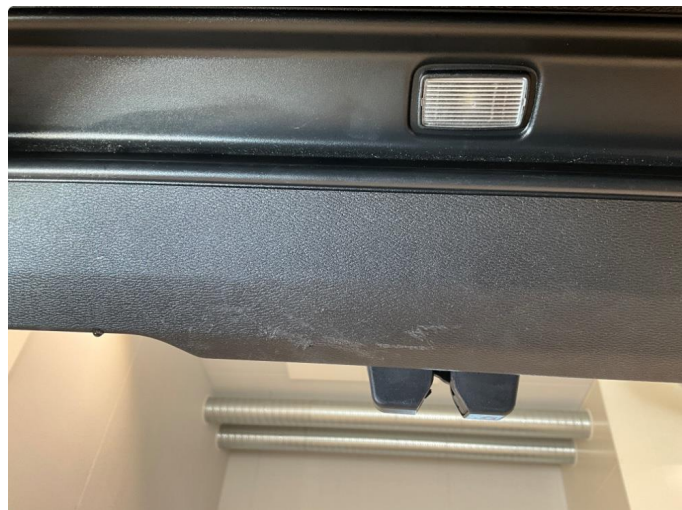
1.2 Skrubbermerker på innsiden av bakluken, på trekket.
