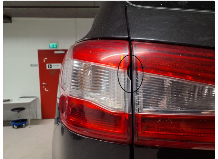
2.1 Mangler en del på baklykt, dette er utenfor pakning, lykta ser tett ut. ingen spor etter fukt eller lekkasje inn
