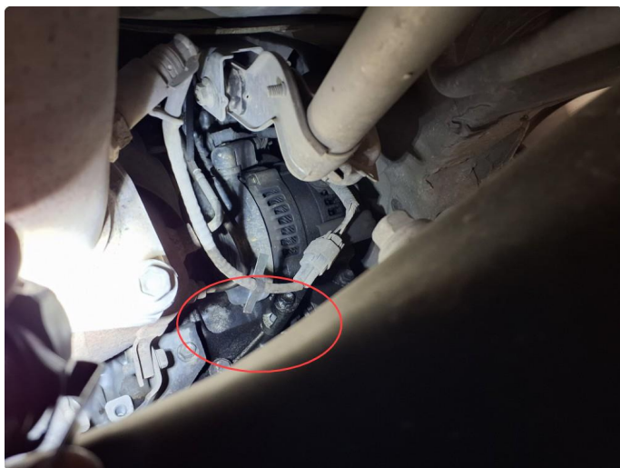
2.1 Oljelekkasje fra motor
