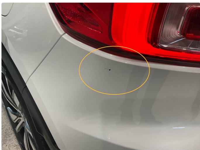
1.3 Lakkskade/ Steinsprut under lykt.
