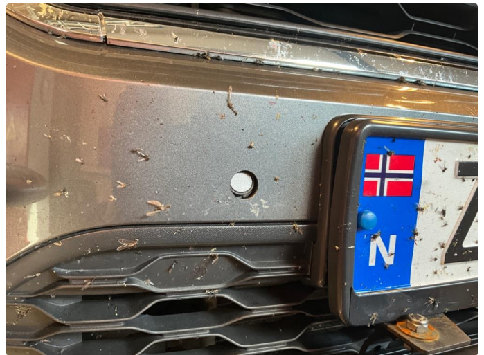
1.1 Begge parkeringssensorer foran er litt løse.
