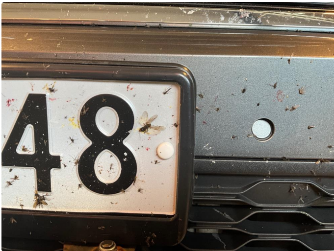
1.1 Begge parkeringssensorer foran er litt løse.
