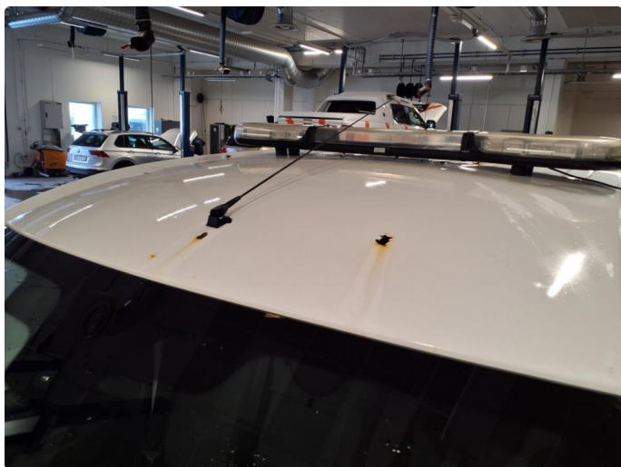
1.7 Rustflekker på tak.
