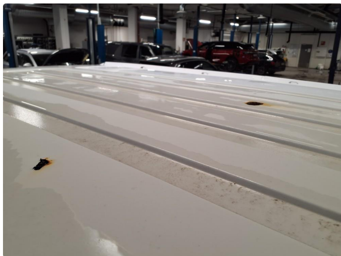
1.7 Rustflekker på tak.
