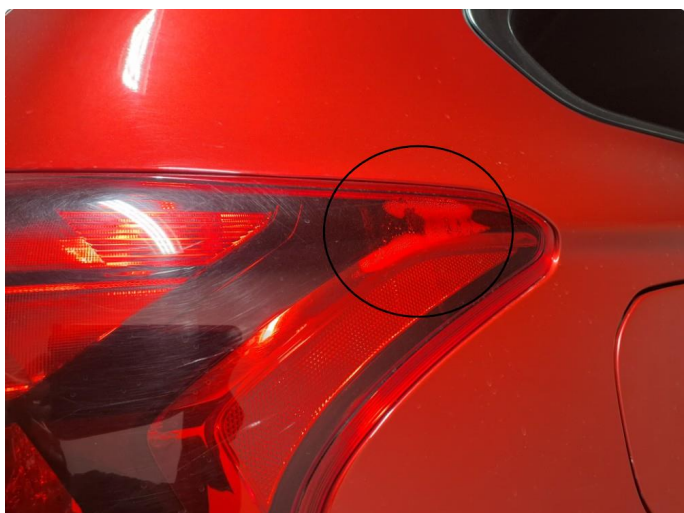
2.1 Tegn til dugg/fukt i lykt
