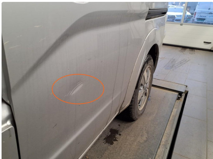
1.1 Bulk med lakkskade på skyvedør
