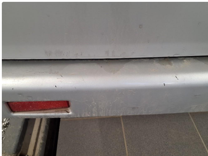
1.2 Slitasje på innlastnings sone til bagasjerom.
