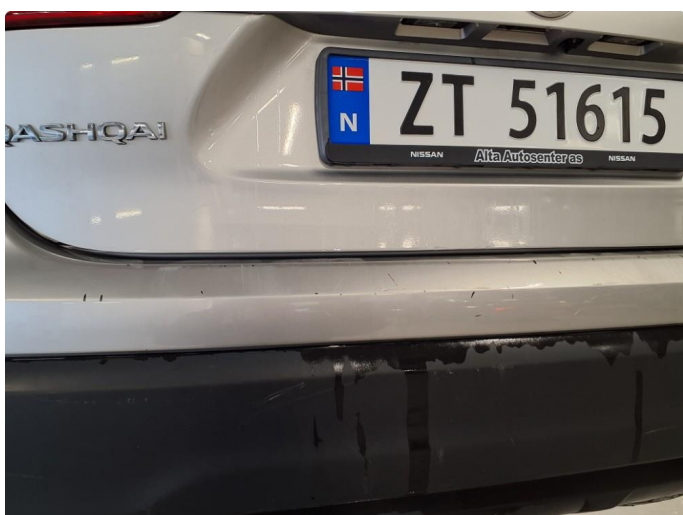
1.3 Noen riper på støtfanger
