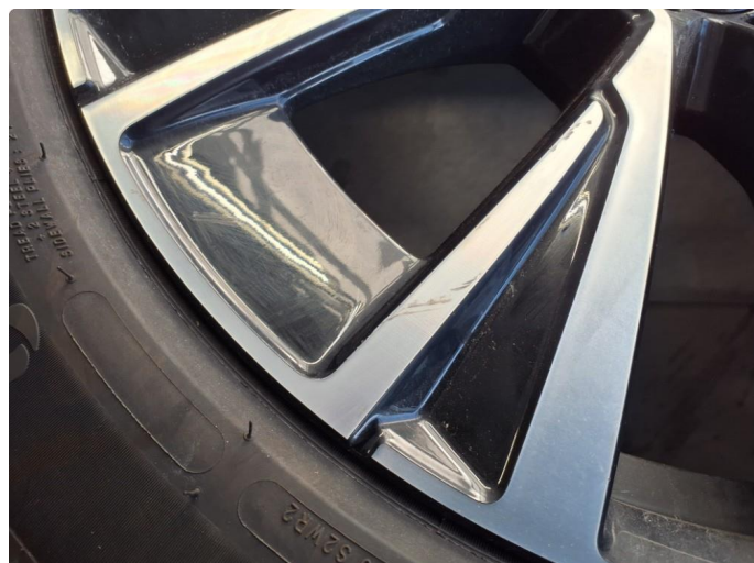
1.2 Kantkjørt felg på 2 av sommerdekkene små bruksmerker
