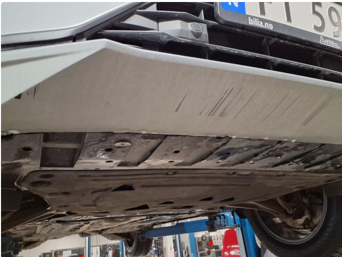
1.3 Skrubbermerker underkant av støtfanger foran
