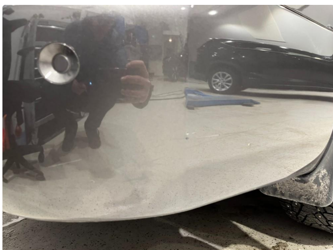
1.5 Dypere riper på støtfanger bak, høyre side. Må rettes og lakkes om man skal få dette bort
