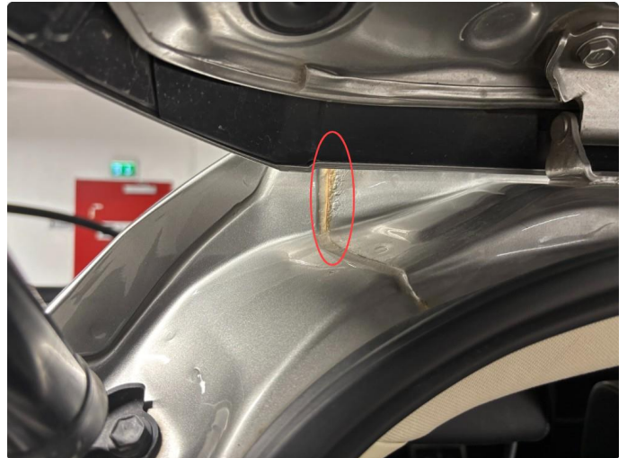
1.6 Rust i åpning til bakluke
