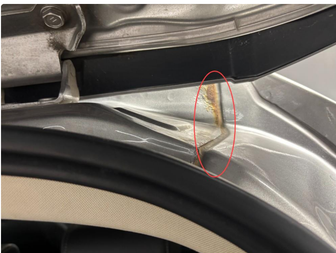
1.6 Rust i åpning til bakluke
