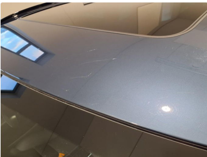
1.5 Noe riper på taket
