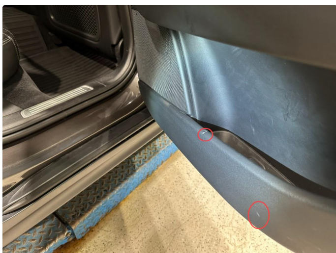
2.1 Skadet/merker etter utstyr
