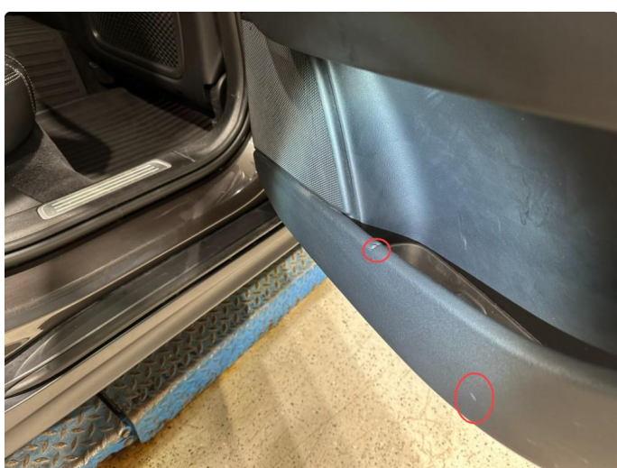
2.1 Skadet/merker etter utstyr
