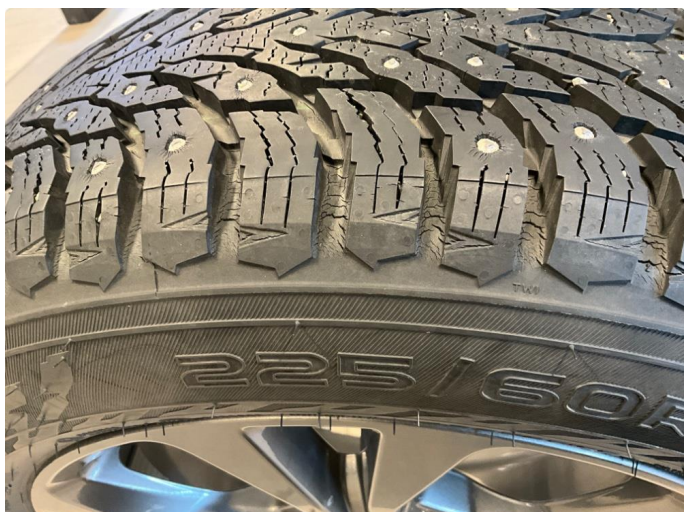
1.1 Noen små sprekker i vinterdekk. Har ingen betydning for bruk.
