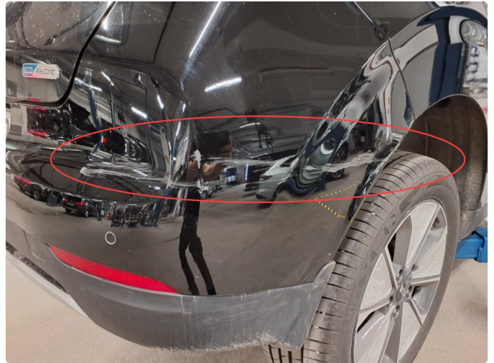
1.5 Skade på bakfanger høyre side
