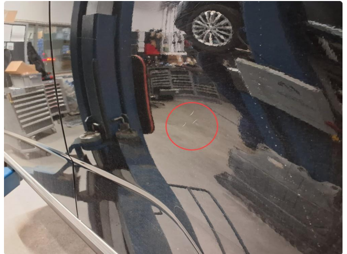
1.3 Merke i lakk venstre dør bak
