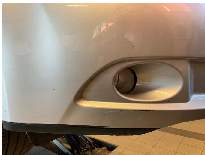
1.1 Generelt mye bruksmerker rundt om på bilen. Noen bulker.
