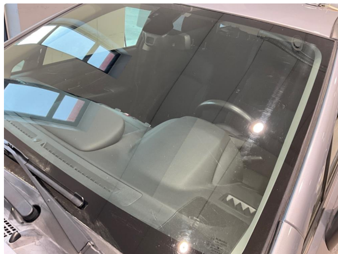
1.7 En del slitasje og bruksmerker på frontrute.
