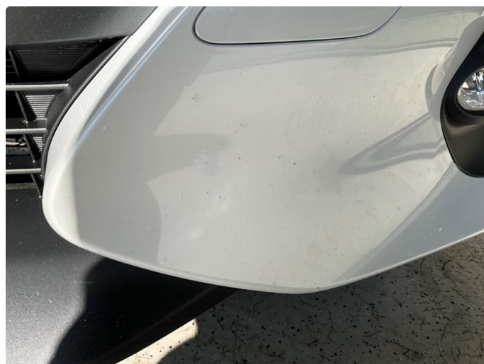
1.3 Noe steinsprut foran tåkelys.
