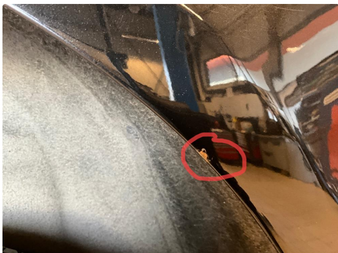
1.1 Rust i fals på høyre bakdør.
