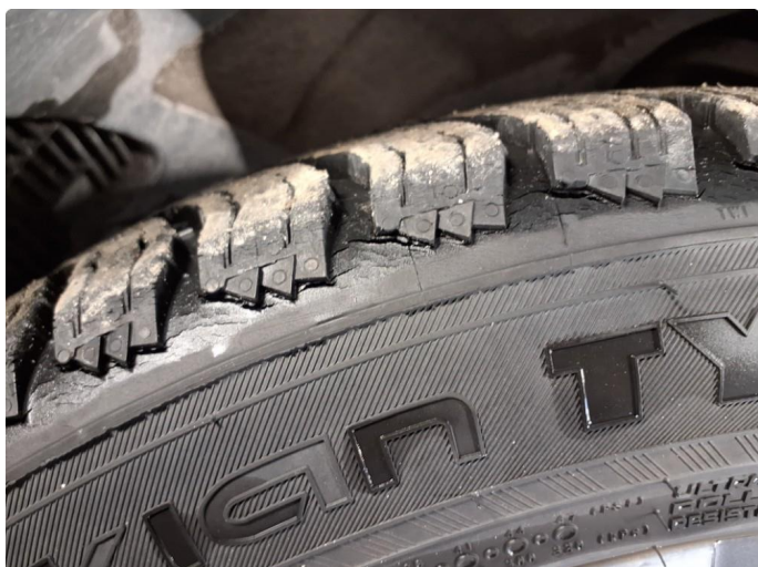
1.2 Noe krakelerte vinterdekk. 275/45R20. Har ingen betydning for bruk.
