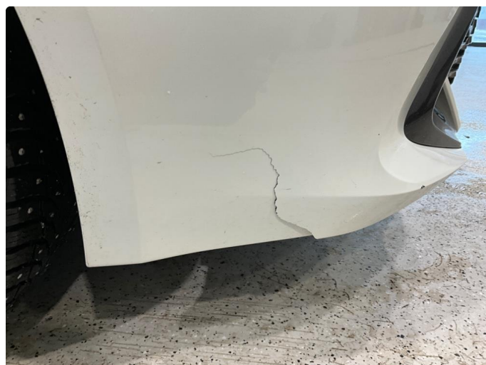
1.4 Støtfanger er sprukket på høyre side.
