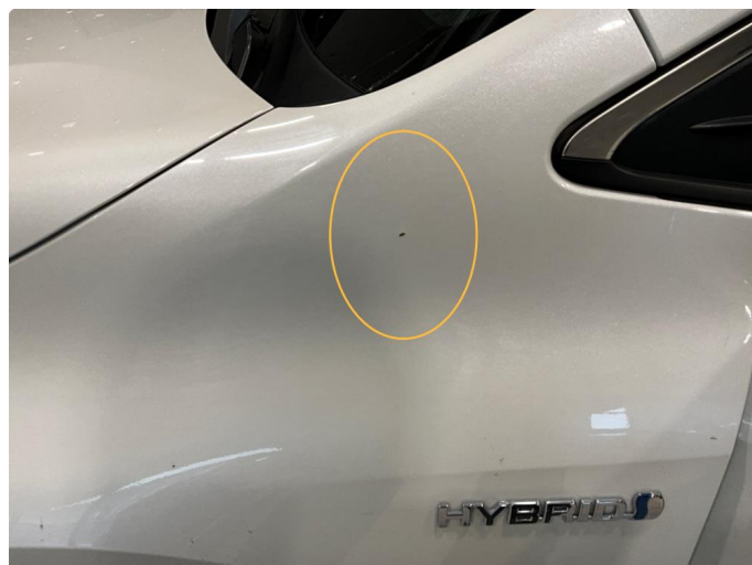
1.2 Steinsprang på skjerm. Venstre foran.
