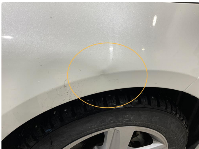
1.1 Liten bulk med lakkskade. Høyre foran.
