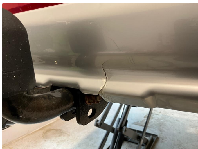
1.4 Sprekk i støtfanger bak.
