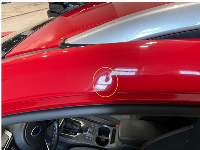
1.7 Liten bulk på stolpe over førerdør.
