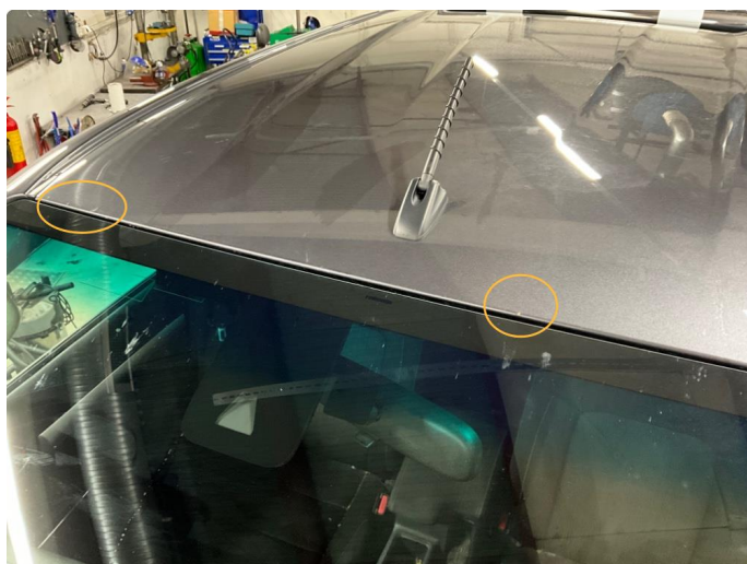
1.9 Steinsprang med rust. Over frontrute.
