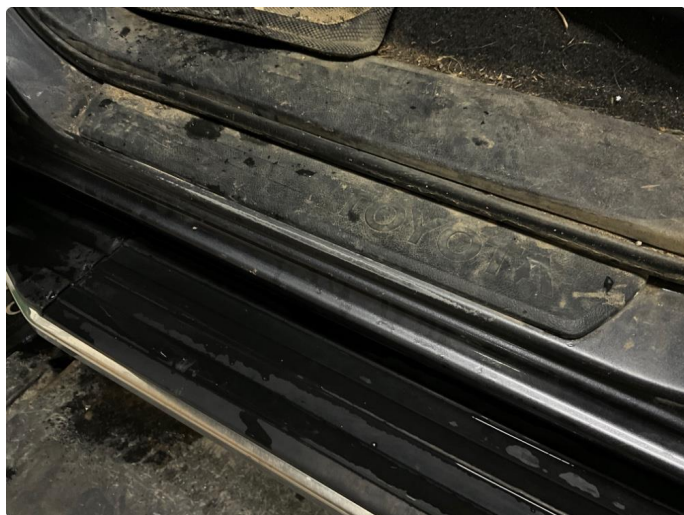
1.8 Slitt innsteg og noen skader i døråpning.
