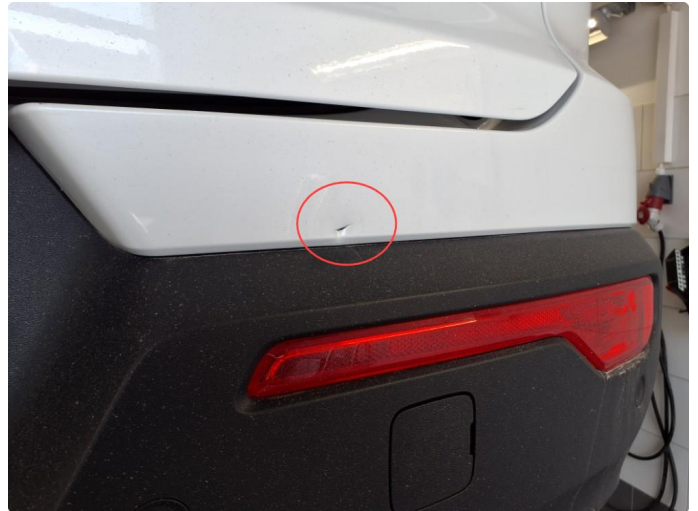
1.2 Merke i Bakfanger høyre side
