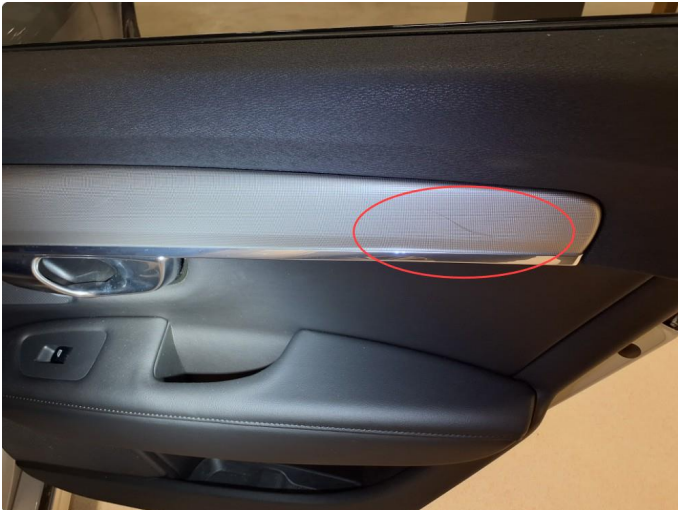
3.1 Merke i dørtrekk høyre bak
