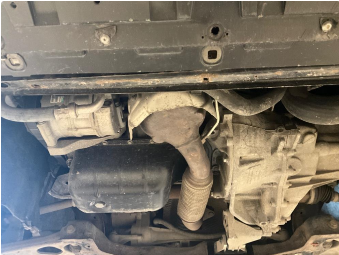
3.5 Beskyttelsesplate under motor mangler.
