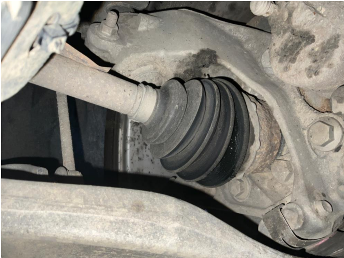
5.2 Defekt mansjett. Venstre Ytre Foran
