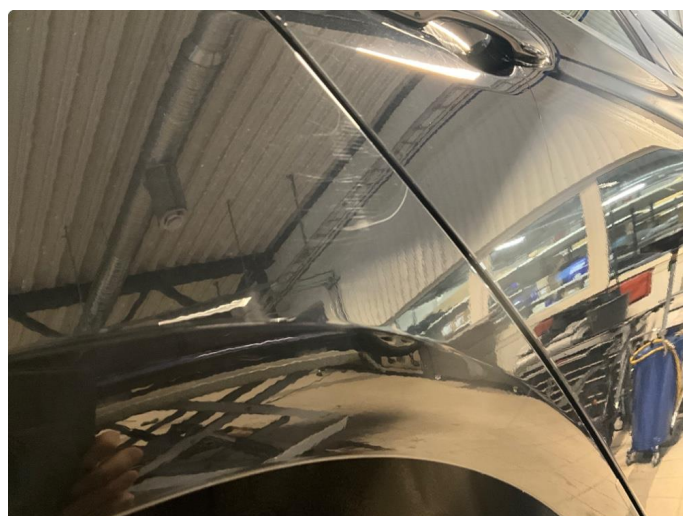
1.5 Noen riper på skjerm mot dør. Høyre bak.
