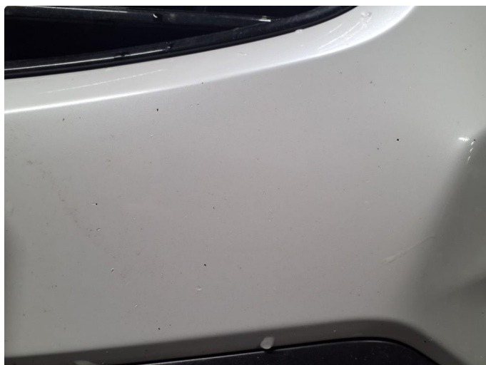
1.2 Noe steinsprut på frontfanger
