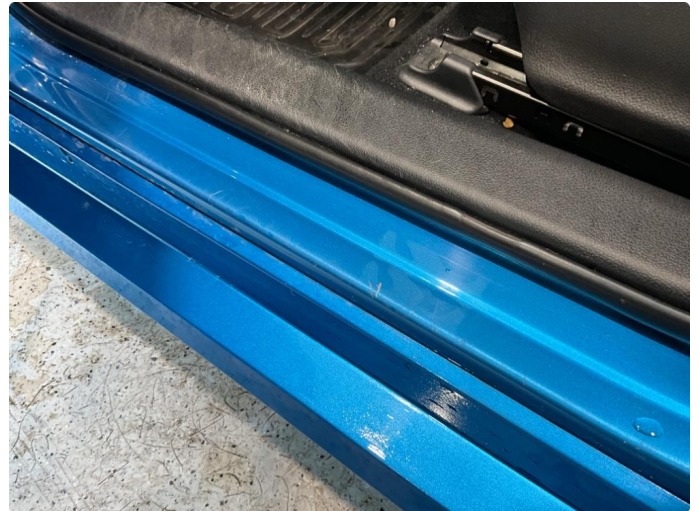
1.2 Slitasje på innsteg. Venstre foran.
