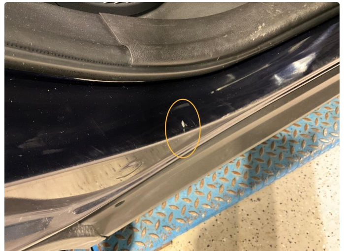
1.3 Noe riper og småbulker i døråpning. Høyre bak.
