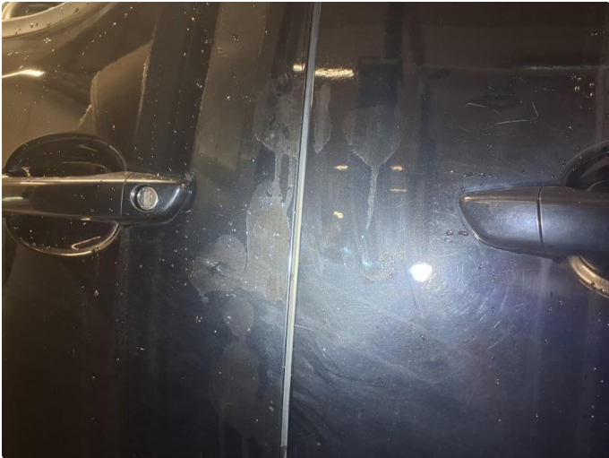
1.2 Øvrige feil Lakkforurensing, gikk ikke bort.
