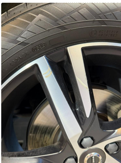
1.5 Kantkjørt felg høyre foran
