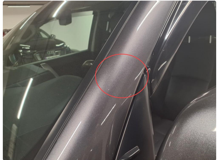
1.2 Steinsprut på stolpe. førerside.
