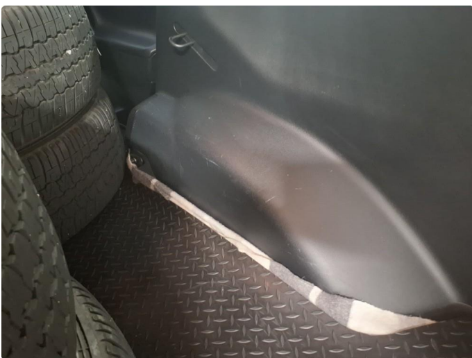
2.2 Merker i sidevegger i varerom.
