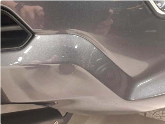
1.1 Steinsprut på støtfanger foran.
