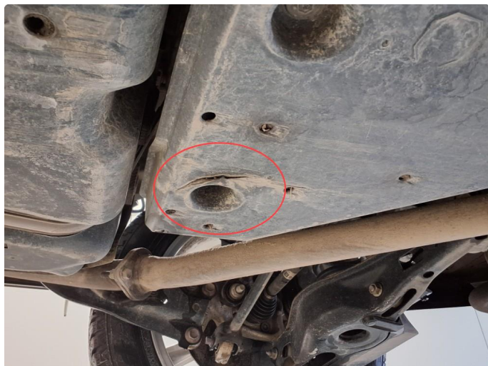
1.2 Skade på beskyttelses plate
