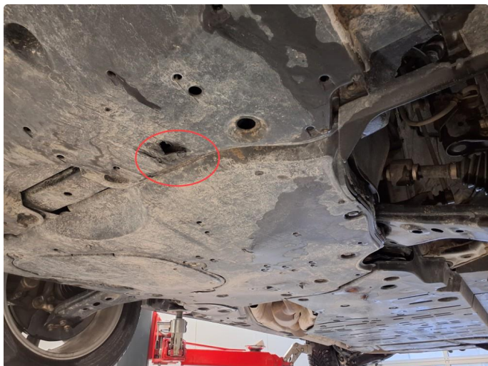
1.1 Skade på beskyttelses plate
