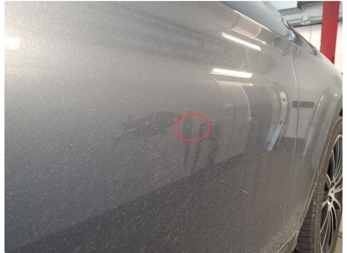
1.2 Liten bulk med lakkskade
